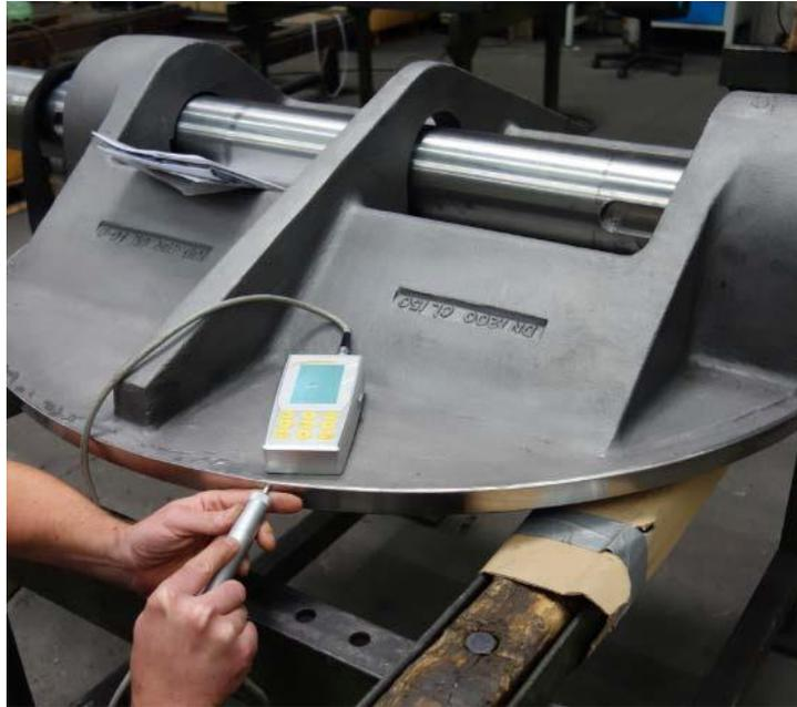
Le contrôle de dureté sur a tige de la vanne, partiellement endurcie sur la zone de roulement, et avec un service de haute température supérieur à 750 °C:
