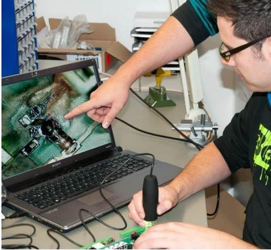
Localisation d'une panne dans un atelier en utilisant le microscope PCE-MM 200
