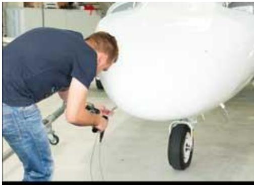
Des petits corps externes, des vis desserrées pourront terminer dans les turbines, les dommages causés par des corps étrangers (Foreign Object Damage) peuvent être détectés correctement. On peut examiner plus de composants, pour cette raison, les examinateurs peuvent inspecter l'intérieur du fuselage (les fissures).
