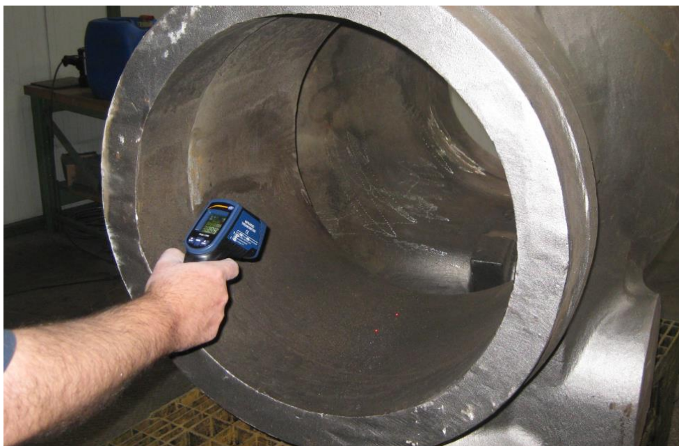
Comprobación de una válvula de retención
