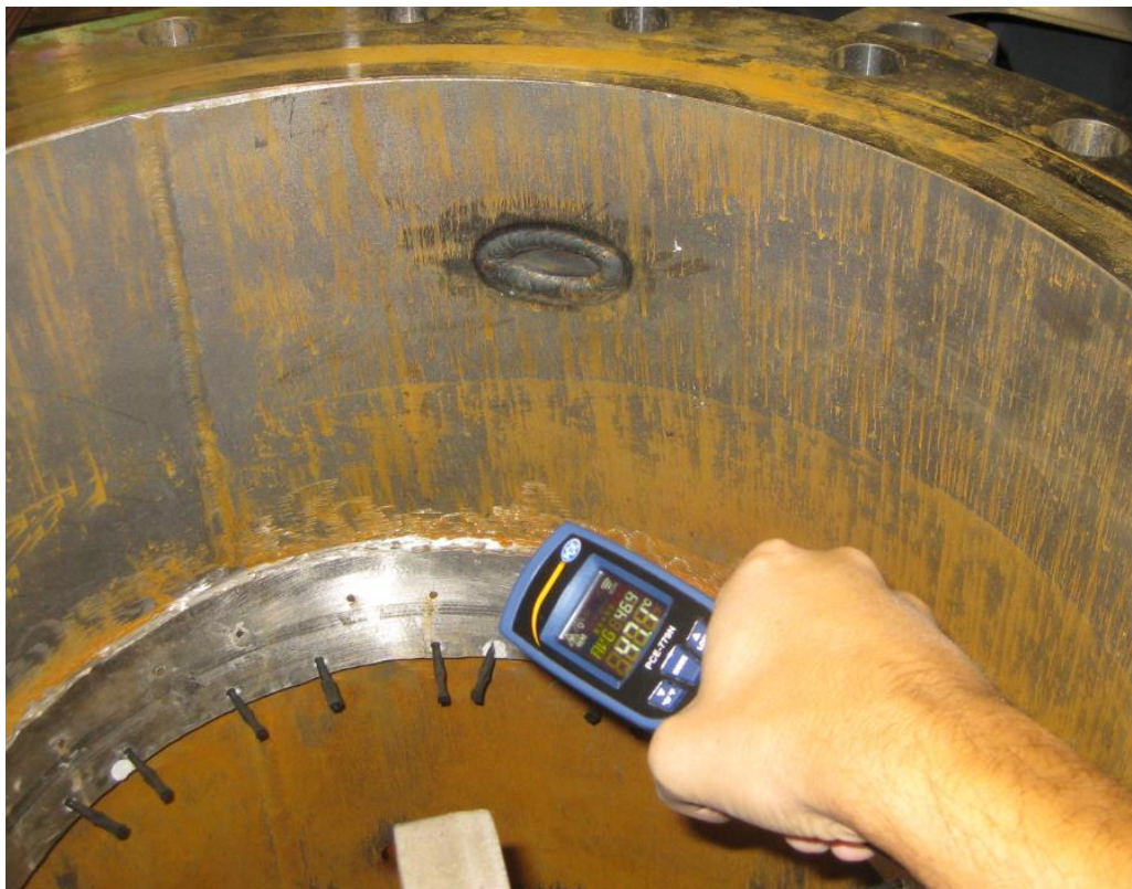
Comprobación de temperatura dentro del cuerpo de la válvula
