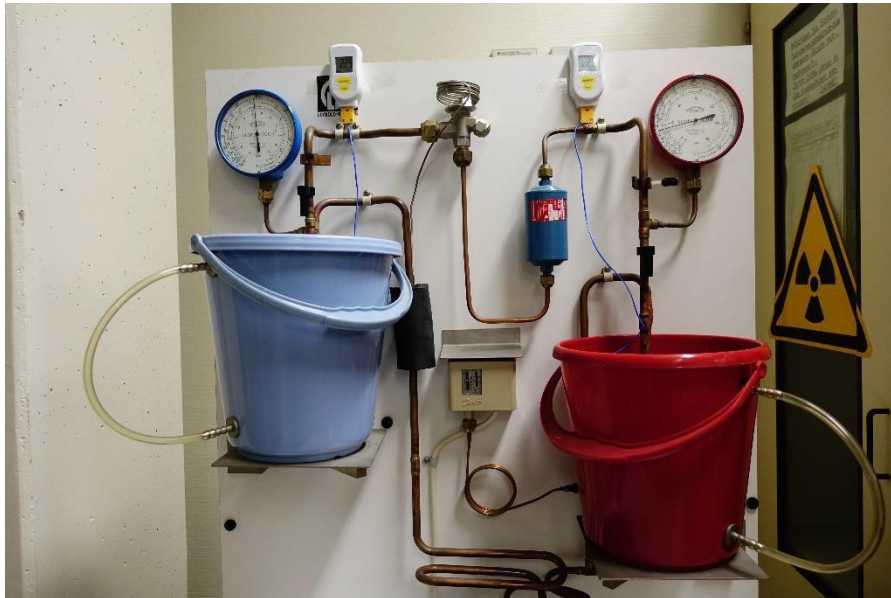
Medición de la temperatura en el modelo de bomba de calor para el cálculo del rendimiento
