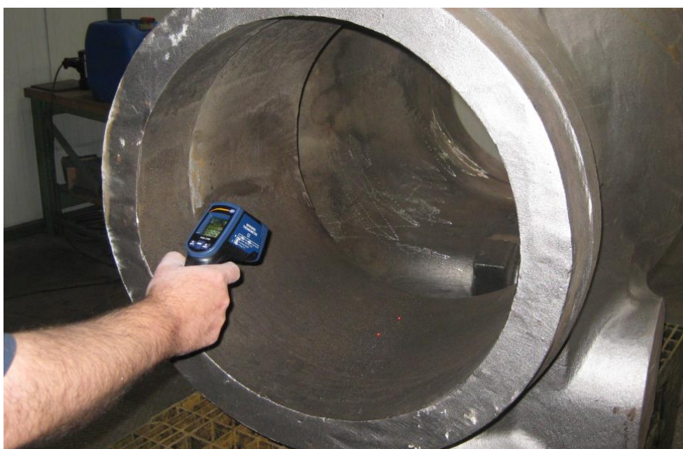
Comprobación de una válvula de retención
