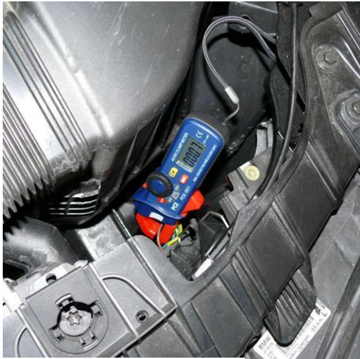
Comprobación de la electrónica en un vehículo con el PCE-DC 1
