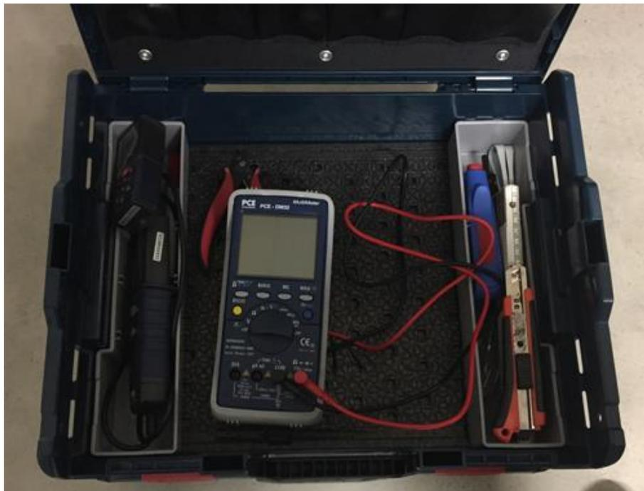
A parte de las funciones de multímetro típicas, el PCE-DM 32 tiene una interfaz serial, que me permite transferir valores de medición al PC. En comparación con otros multímetros de la gama de precios, el multímetro ofrece una pantalla muy grande en la que a parte de los valores de medida, también se indica en que casquillos deben de introducirse los cables de medición.
