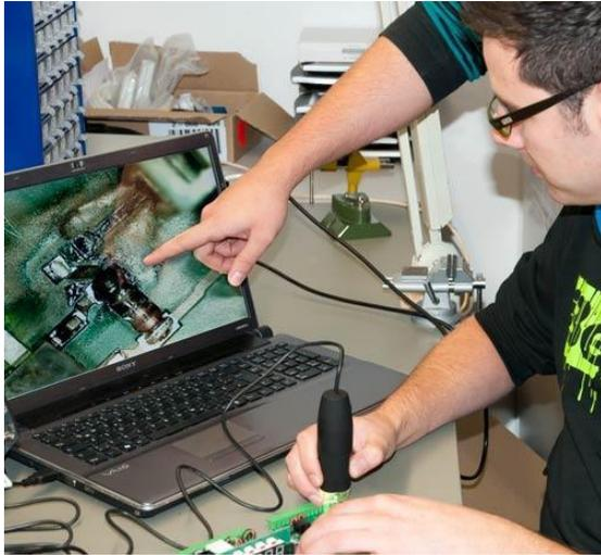
Localización de una avería en un taller usando el microscopio PCE-MM 200
