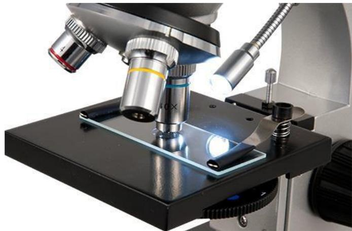
Encima del pie se encuentra el trípode, sobre el que se fija la platina y el portamuestras. Antes que la luz alcance el preparado, esta se enfoca a través de la lente del condensador.
