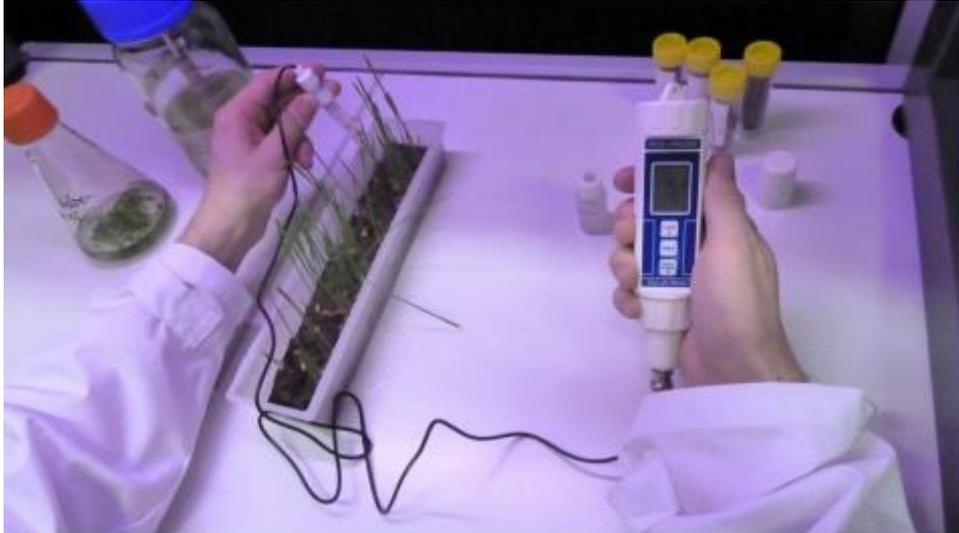
Imagen: uso del medidor de pH de suelo en el laboratorio de un colegio.
