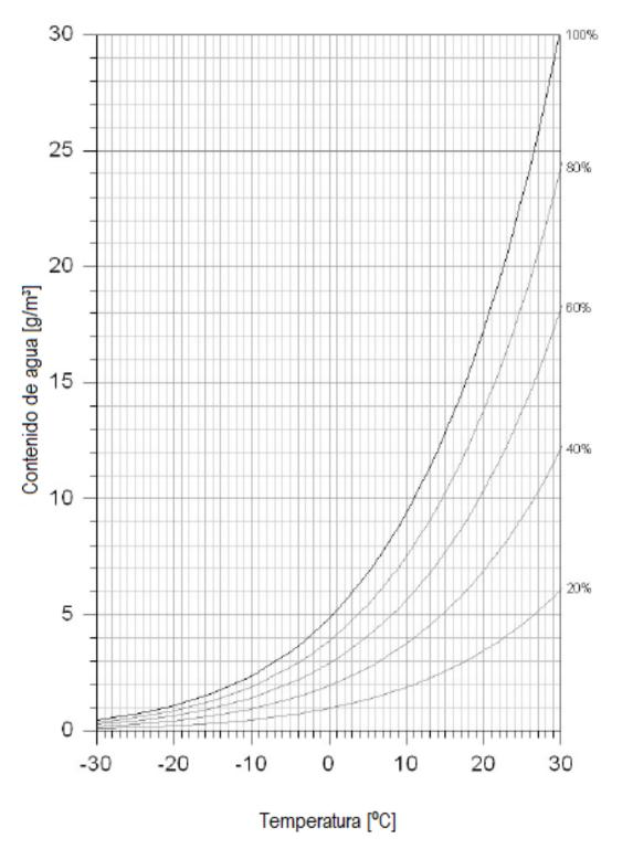
Información adicional del contenido absoluto de agua (Sección: Medidor de humedad)
