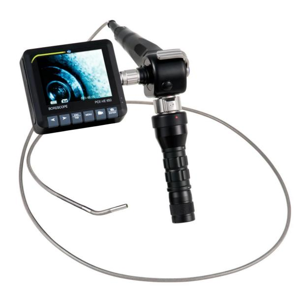
La inspección de piezas en puntos de difícil acceso requiere un cabezal articulado y una pantalla de buena visibilidad. Aquí destaca el endoscopio PCE-VE 650, pues el cabezal es direccionable y la pantalla es giratoria y extraíble. Esto permite trabajar en sitios con poco espacio.
