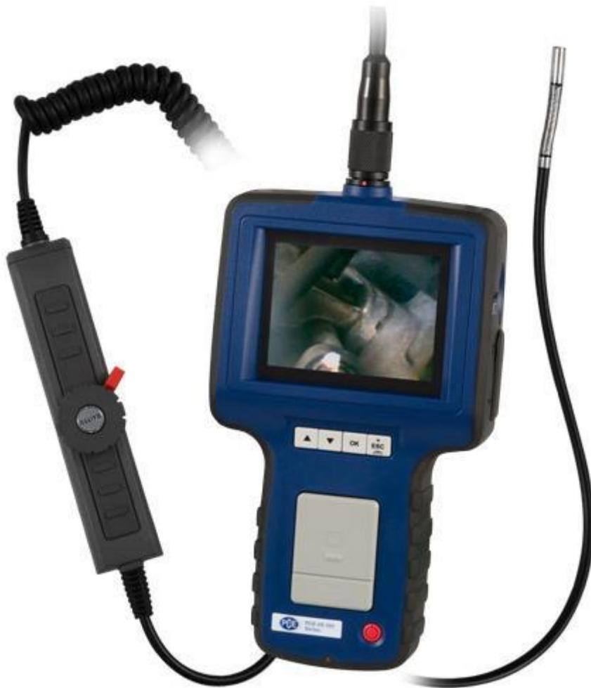
El videoendoscopio PCE-VE 350N3 cumple de manera óptima tales exigencias, pues dispone de las siguientes características: robusto, flexible (longitud: 3 m / Ø 6 mm), cabezal direccionable con iluminación de 4 LED integrada, distancia de visión entre 1,5 y 10 cm, posibilidad de documentar fotos y vídeos en tarjeta de memoria de 2 GB.
