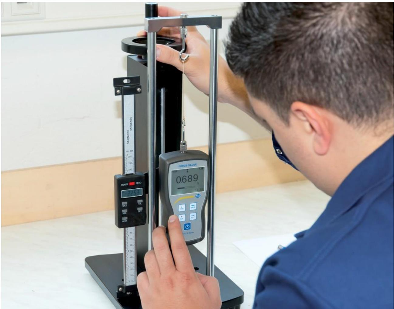
Un medidor de fuerza es útil hasta en las aplicaciones menos esperadas, por ejemplo, hay un lector especial de la fuerza de los huevos, un dispositivo que ayuda a medir el nivel de fuerza necesario para romper la cáscara de un huevo. Al utilizar este dispositivo es posible encontrar la mejor manera de transportar y comercializar el producto
