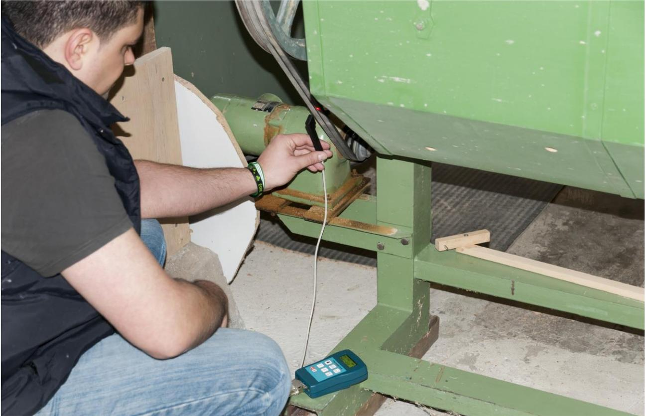
**Dispositivo para la medición de la tensión de una correa**
