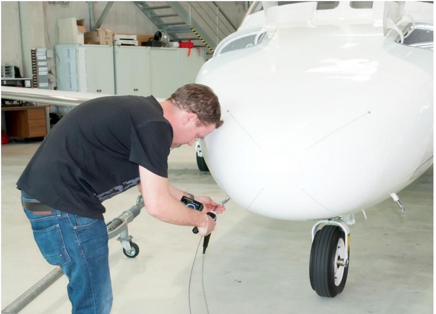
Pequeños cuerpos externos, tornillos aflojados podrían terminar en las turbinas, los daños causados por cuerpos extraños (Foreign Object Damage) pueden ser detectados correctamente. Se pueden examinar más componentes, por tanto, los examinadores pueden inspeccionar el interior del fuselaje (las grietas).
