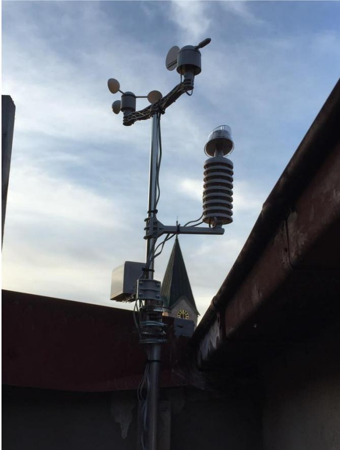
Ich musste zum Beispiel erst einen Balken an der Wand montieren um den Dachvorsprung zu überwinden und um die Montageumgebung zu schaffen. An diesen Balken montierte ich dann noch ein Rohr um auf die entsprechende Höhe zu kommen. Diese Materialien kann man in jedem Baumarkt bekommen. Preis zusätzlich ca. 20,00 €.
