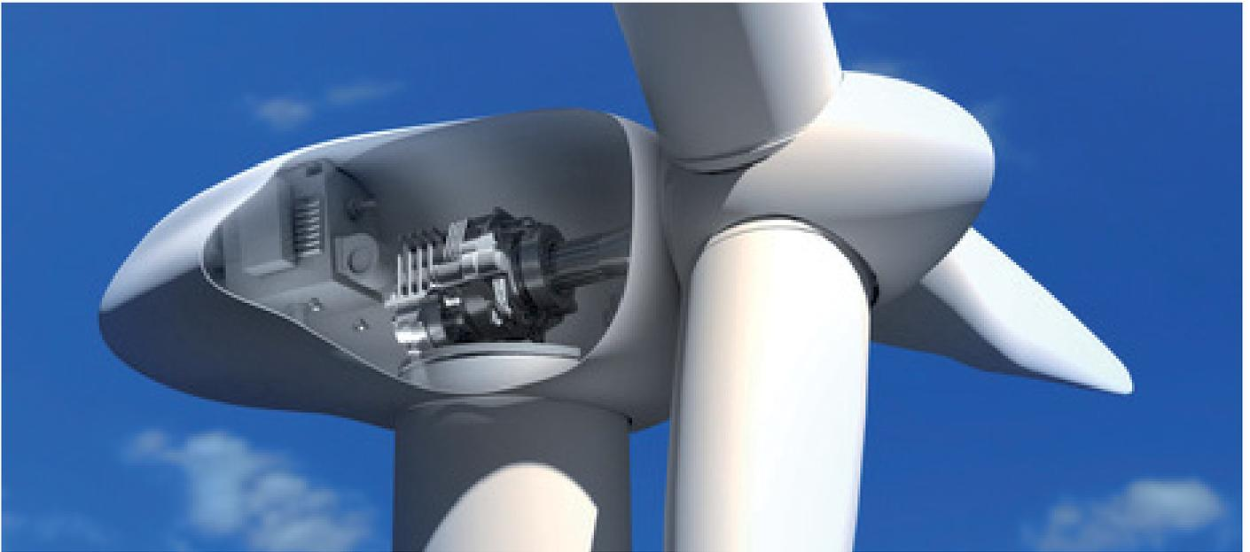
Windkraftanlagen unterliegen großen Kräften, die zu erhöhtem Verschleiß führen. Auch bei dieser Art von Krafterzeugern werden Videoendoskope zur Inspektion eingesetzt. Besonderes Augenmerk gilt hier dem Getriebe. Es befindet sich in einer Höhenlage, die es nicht erlaubt, das Getriebe kurzfristig zu tauschen (bei OffShore-Anlagen noch schwieriger).
