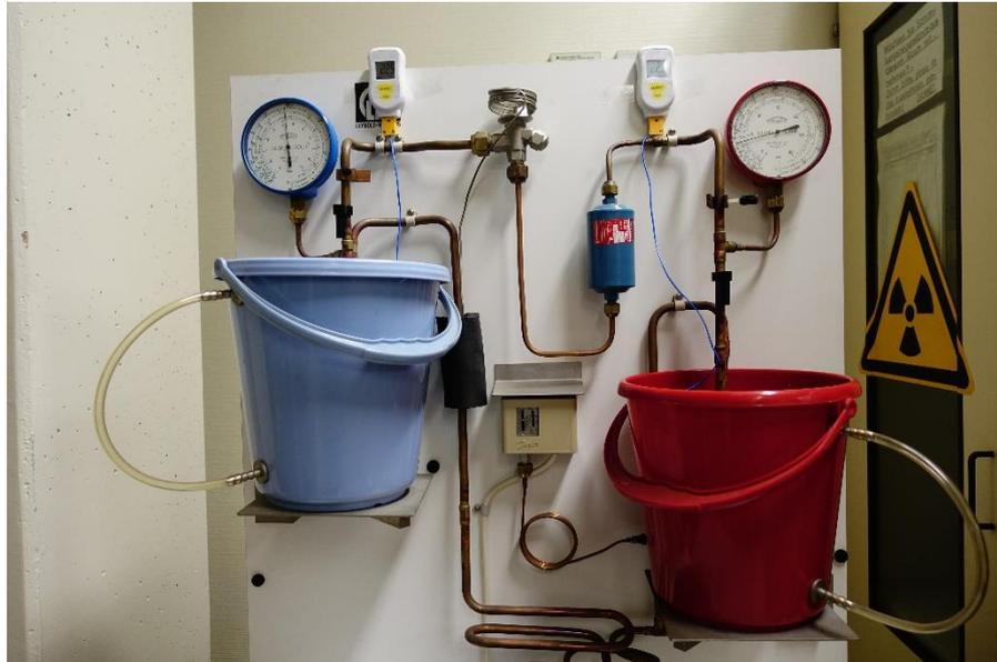
Temperaturmessungen am Wärmepumpenmodell zur Leistungsermittlung
