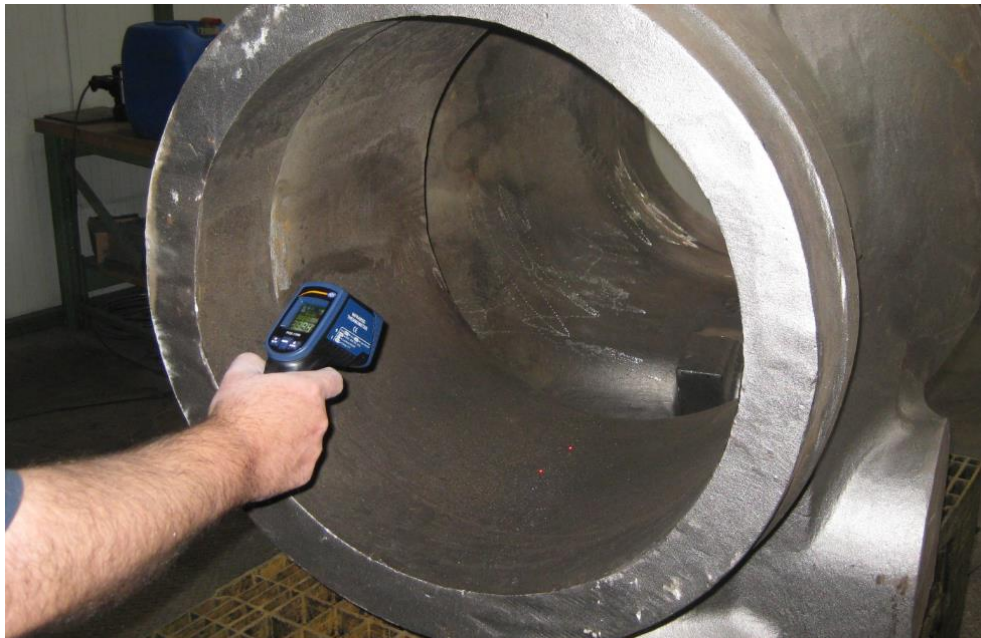
Überprüfen einer Rückschlagklappe
