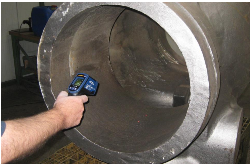
Überprüfen einer Rückschlagklappe
