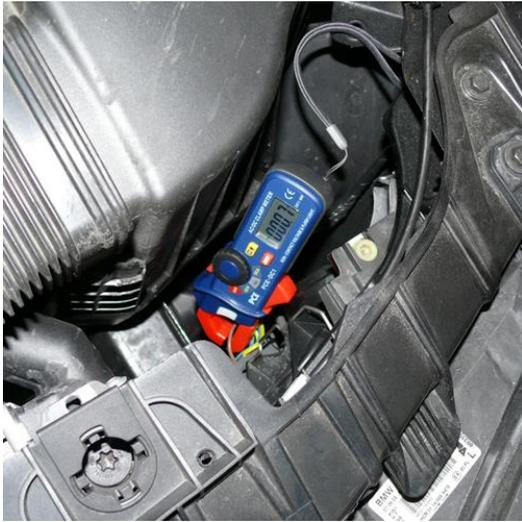
Elektronik-Check im KFZ-Bereich mit dem PCE-DC 1
