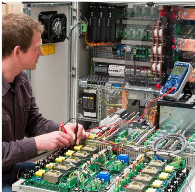
Qualitätskontrolle mit dem Multimeter PCE-DM 32
