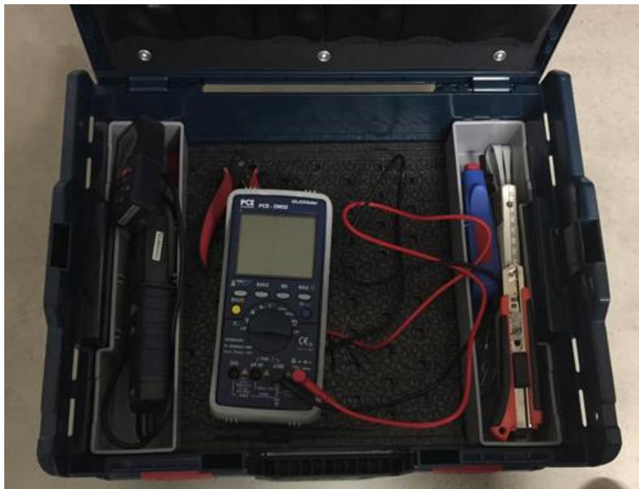
Neben den typischen Multimeterfunktionen besitzt das PCE-DM 32 eine serielle Schnittstelle, die es mir ermöglicht Messwerte auf meinen PC zu übertragen. Im Vergleich zu anderen Multimetern aus dieser Preisklasse bietet das Multimeter wirklich ein echt großes Display wo neben den Messwerten auf angezeigt wird, in welche Messbuchsen die Messleitungen gesteckt werden sollen.
