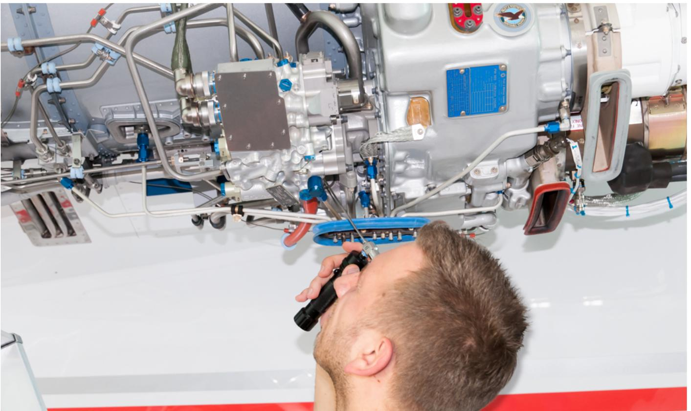
Moderne Inspektionskamera mit seitlicher Sichtfunktion (Zweitkamera) oder voll schwenkbaren Kameraköpfen machen den Einsatz von Spiegeln unnötig. Bei der Inspektion von Turbinen (Flügelrad, Verdichterstufen, Brennraum, Turbinensatz und Düse) ist z.B. eine große Anzahl an Schaufeln (Vogelschlag - gelöste Teile) zu analysieren. Werden die Turbinenscheiben (Blisks) im ausgebauten Zustand untersucht, entfällt ein Drehen der Gasturbine.
