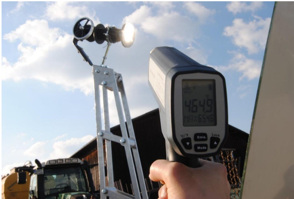
Abb. 31. Messung der Temperatur am Erhitzerkopf
