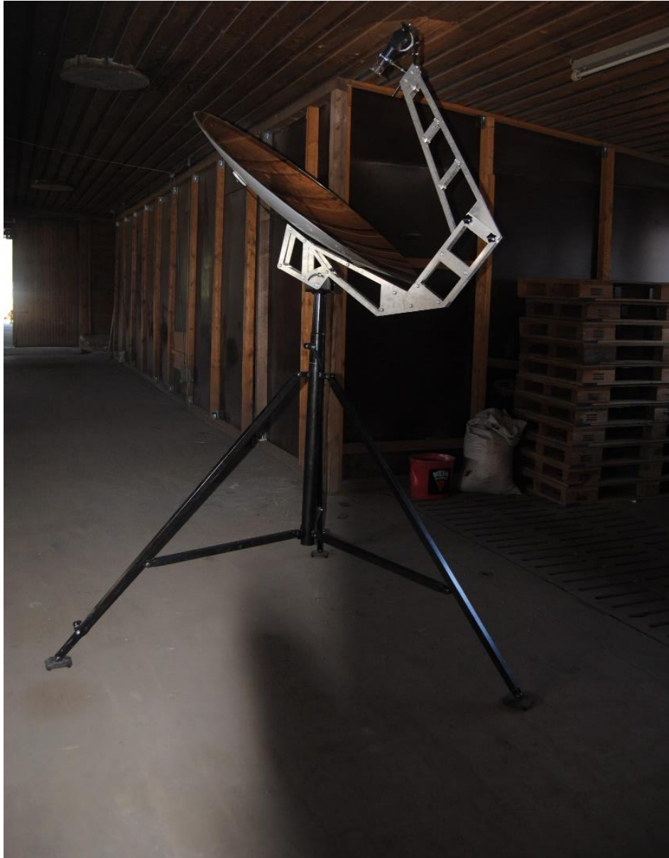
Abb. 23. Aufgebautes Dish-Stirling Systems
