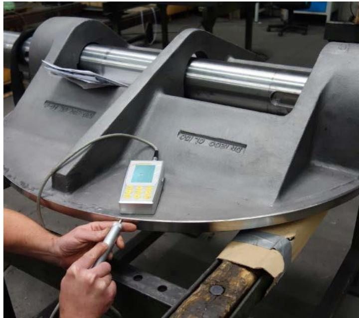
Die Härteprüfung am Ventilschaft, der teilweise im Lagerbereich gehärtet ist und in dem Hochtemperatur-Service über 750 ° C verwendet wird:
