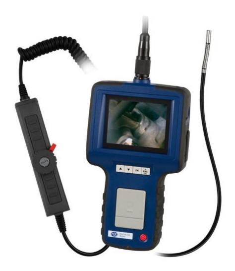
Die Endoskopkamera PCE-VE 350N3 erfüllt optimal diese Anforderungen durch folgende Eigenschaften: robuste, flexible (3 m/d6mm) 2-Wege-Endoskopoptik mit integriertes 4-fach LED-Beleuchtung, Blickfeldtiefe 1,5 - 10 cm, Möglichkeit der Foto- und Videodokumentation auf 2 GB Speicherkarte
