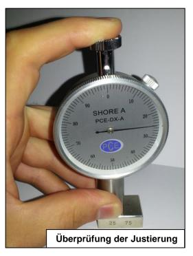
Die Überprüfung der Justierung ist mit Hilfe des beigelegten Werkzeugs möglich. Sollte das Gerät bei der Überprüfung nicht die richtigen Werte anzeigen kann das Durometer nicht selbst kalibriert werden.
