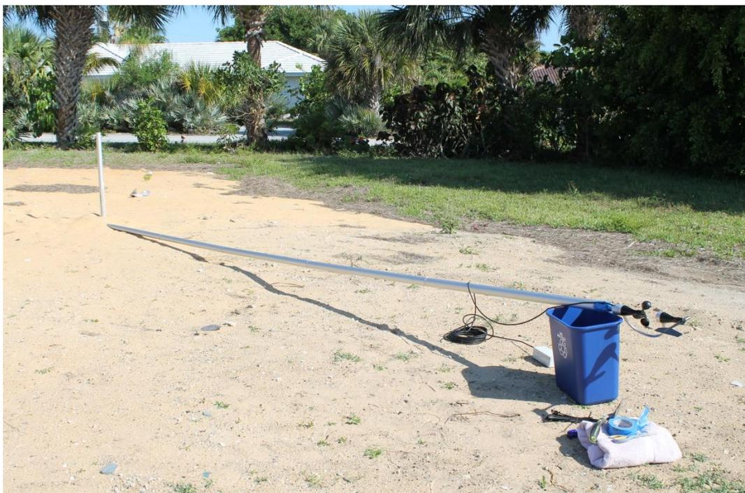
Da der Datenlogger nicht fertig angeschlossen geliefert wurde, konnte Ich das Kabel vom Anemometer noch für meine Zwecke verlängern. Da ich nicht sicher war ob dies problemlos möglich ist, rief Ich kurz bei der PCE Hotline an. Hier teilte man mit, dass eine Verlängerung des Kabels auf 15m kein Problem darstelle. Gesagt, getan, Kabel verlängert und an die Elektronik lt. der bebilderten Bedienungsanleitung angeschlossen.
