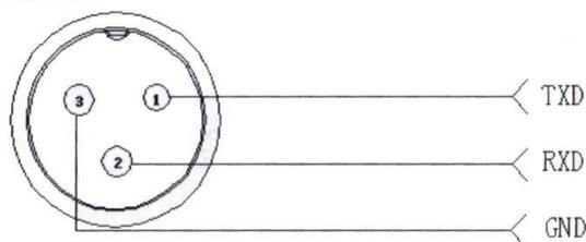
La pantalla tiene una interfaz RS-232 bidireccional con la que podrá controlar la balanza mediante parámetros de consulta. De este modo, podrá consultar el peso que ha registrado la balanza a través del Software para PC y utilizar sus funciones para tratar los datos.
