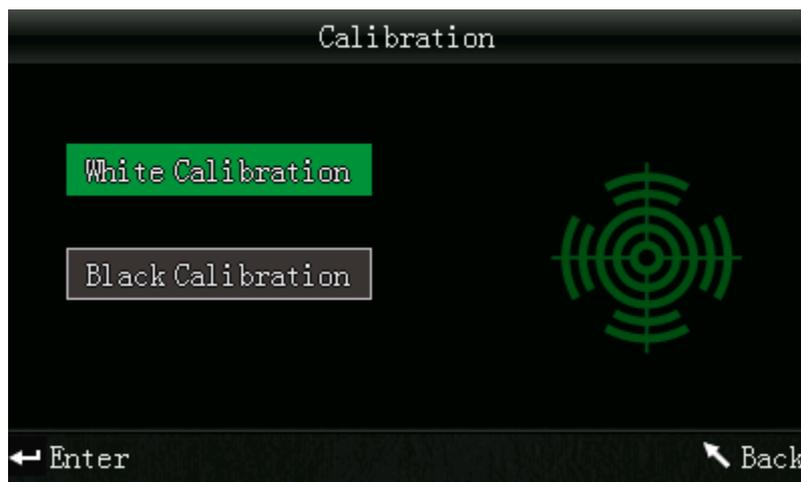
Aquí podrá seleccionar entre la calibración en blanco o negro. Utilice las teclas con flecha para seleccionar el color ( ↑ y ↓ ) y pulse luego la tecla ENTER ↵. Le aparecerá una pantalla de confirmación con las respectivas instrucciones para la calibración.
