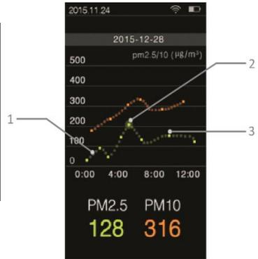
Los valores medidos guardados se pueden ser consultar con las teclas de fecha. Para reiniciar la medición y el registro de datos, pulse de nuevo la tecla "Enter". Para volver al modo de medición normal, mantenga pulsada la tecla "MEM".
