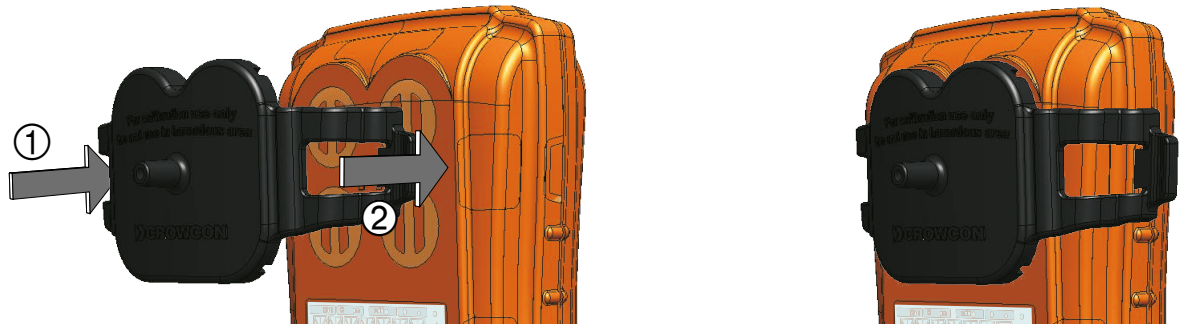
Figura 5: Instalación de la placa de prueba de calibración/contraste
