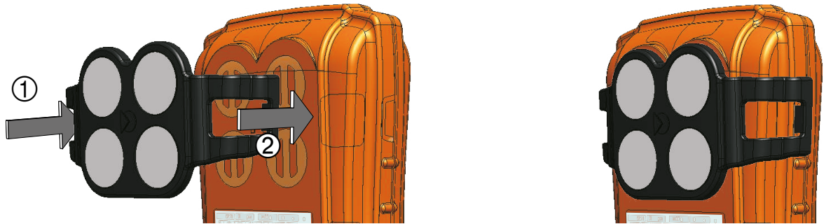
Figura 6: Instalación de la placa del filtro externo
