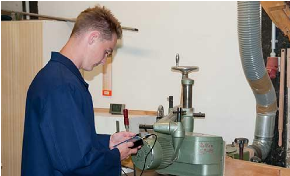
El medidor de vibración PCE-VM 3D durante una medición en un motor
