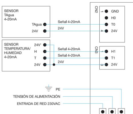
NOTA: todas las conexiones en el PCE-BDT se realizan mediante bornas enchufables, que se proporcionan de serie con el equipo.
