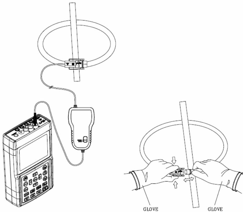
1. Conecte la sonda flexible alrededor del conductor.
