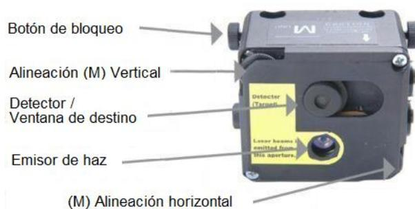
Fig. 1a: Vista frontal y superior del sensor
