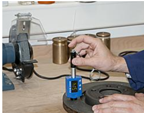
Aquí ve el medidor de dureza para metales PCE-2500 midiendo un disco de frenos.
