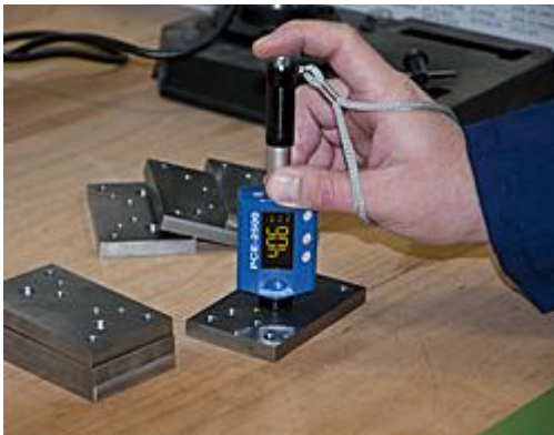
Aquí observe el medidor de dureza para metales PCE-2500 sobre el bloque de metal.
