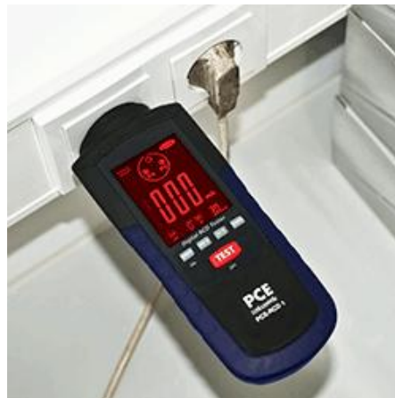
El color de la pantalla cambia a rojo al sobrepasar los valores límite o al no detectar la toma a tierra.
