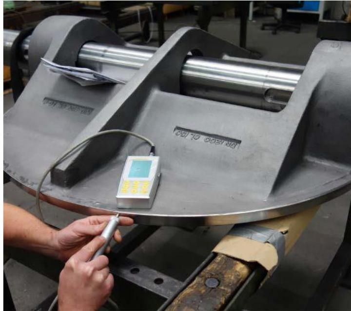
El control de dureza en la varilla de válvula, endurecido parcialmente en la zona de rodamiento, y con un servicio de alta temperatura superior a 750 °C.
