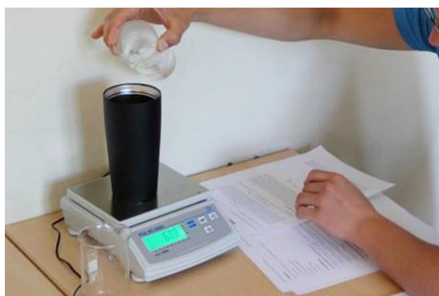
Fig. 3 – Un estudiante determina la capacidad térmica de alcohol
