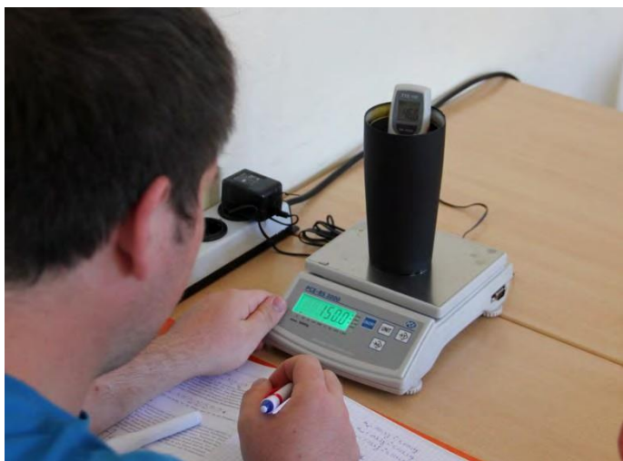
Fig.2 – Determinación de la constante calorimétrica de un recipiente térmico
