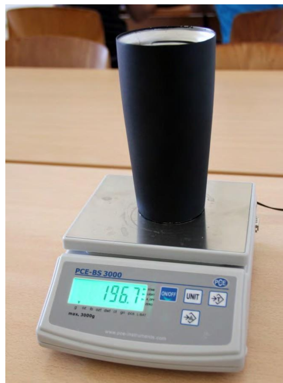
Fig.1 – Determinación del calor de fusión de hielo usando la balanza de laboratorio PCE-BS 3000
