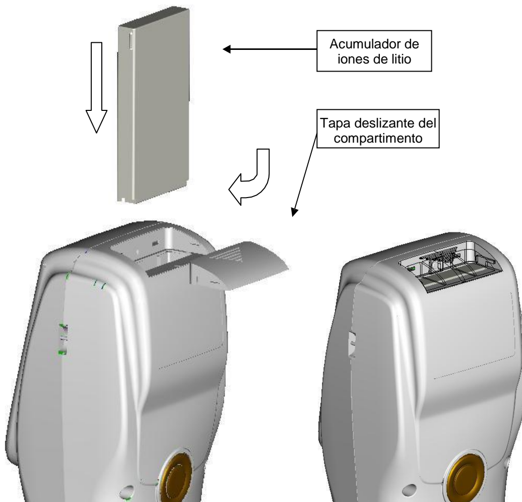
Fig. 2: Instalación del acumulador
