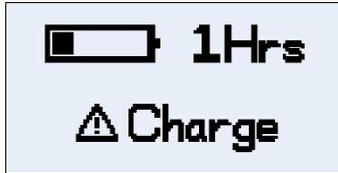
Duración de la batería con la carga actual <1 hora. Carga la batería
