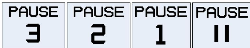
Para continuar la medición, pulse de nuevo la tecla "START STOP". Primero debe activarse la pausa para que pueda completarse el proceso de medición. Si la pausa está activada, pulse la tecla "Enter". A continuación se le preguntará si desea finalizar el proceso de medición. Confírmelo pulsando de nuevo la tecla "Enter". Si no desea cancelar la medición, pulse la tecla "START STOP".
