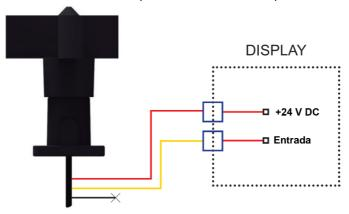
Conexión de tres hilos para conexión directa a un SPS, por ejemplo
