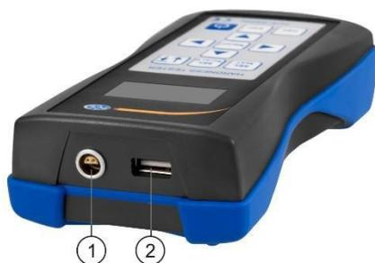
1. Conexión del sensor
