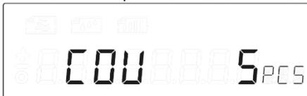
3. Pulse **ON** para seleccionar la cantidad a colocar en la balanza y luego pulse **Tare** para confirmar.
