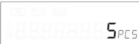
5. Después de contar, pulse **ON** y seleccione "peso". A continuación, confirme con **Tara** para volver a la pesada normal.
