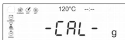
⇒ Esperar la aparición, parpadeando, del valor de masa de la pesa de ajuste.
