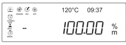
⇒ Mediante la tecla
