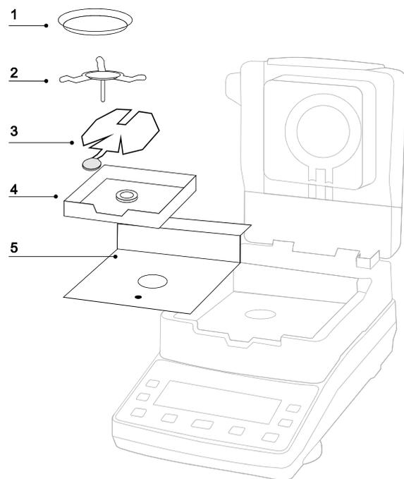
Abrir la tapa de calentamiento y sacar consecutivamente todos los elementos. No usar agentes agresivos (disolvente, etc.). Limpiar el aparato únicamente con un paño humedecido con lejía de jabón. Los líquidos no han de penetrar al interior del aparato. Secar con un paño seco y suave. Los residuos sueltos de las muestras/el polvo pueden eliminarse mediante un pincel o un aspirador manual.
