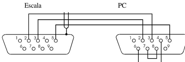
**Conectar cable WD-1 (conectar la impresora con la balanza):**
