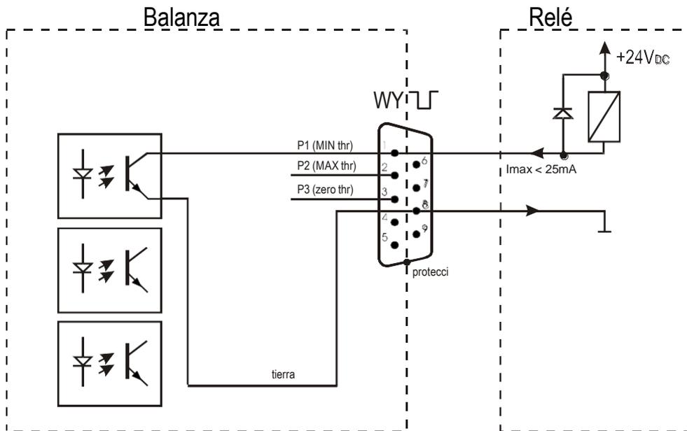
La salida relé es la salida del transmisor de colector abierto con capacidad de carga de 25mA / 24V. Las entradas del transmisor deben protegerse con diodos, por ejemplo, 1N4148.
