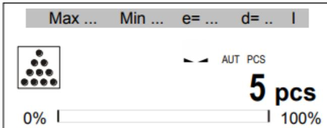
La balanza muestra la cantidad de piezas. Coloque una porción de las piezas y para terminar de trabajar con la función, pulse MENU, seleccione Applications y, a continuación, PCS y Deactivation.
