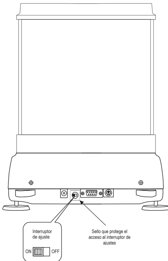
Las balanzas cumplen con los requisitos de verificación, la realización de la calibración requiere el cambio de posición del interruptor de ajuste, que se coloca detrás de la marca de protección (etiqueta adhesiva) de un organismo notificado. El acceso al interruptor sólo es posible después de quitar la marca.
