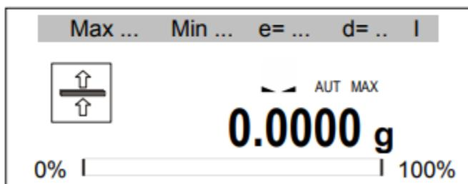
Pulse →T← causa la puesta a cero de la balanza y permite iniciar la siguiente serie de pesaje.
