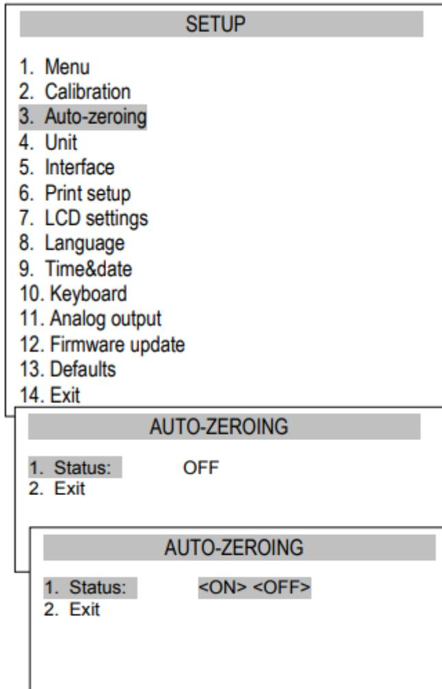
Para activar la función, utilice las teclas de navegación y la tecla ENTER, seleccione Status ON
