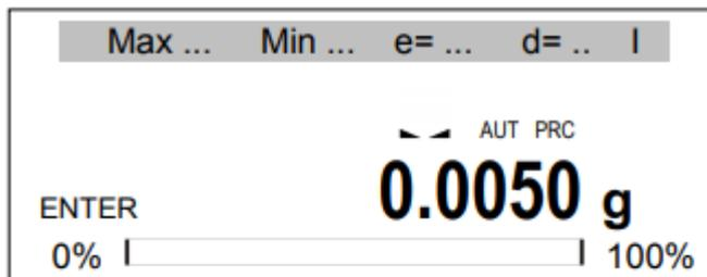
Coloque la muestra de referencia (100%) y pulse ENTER,
