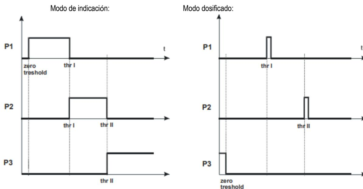
En modo *Batching* (modo de dosificación) en las salidas P1 (*thr I*) y P2 (*thr II*), los impulsos de cortocircuito aparecen por un tiempo de 0,5s. El estado de cortocircuito de la salida P3 (cero) aparece cuando la indicación no excede el valor umbral señalando carga cero.
