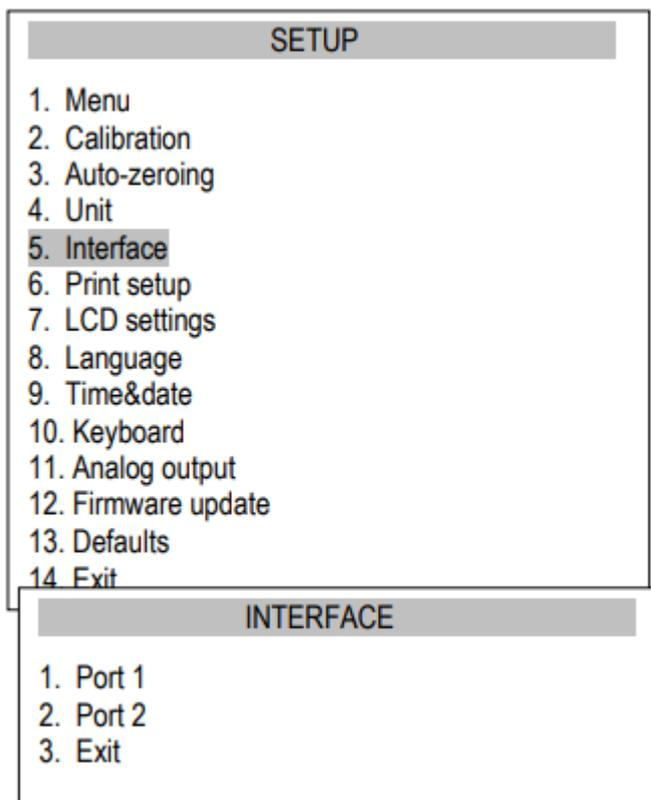
La función permite configurar de forma independiente los parámetros de comunicación de ambos puertos serie, Puerto-1 y Puerto-2 (ejecutados en RS232C, RS485, USB o LAN estándar):
