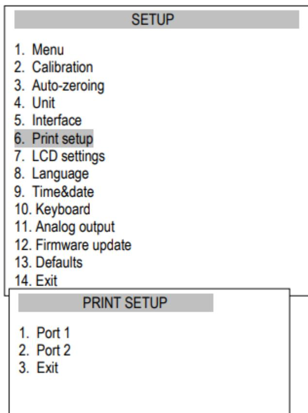
La función se utiliza para imprimir información adicional almacenada en la memoria de la balanza, datos de identificación del producto pesado e identificación del operador de la balanza. Esa información se inscribe utilizando las teclas de escala o el escáner.
