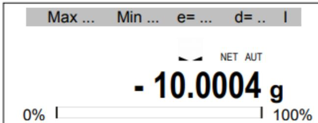
Después pulse →T← o descargue el plato de pesaje, la balanza mostrará la indicación mínima (resta valor de tara). Para finalizar el trabajo con esta aplicación, pulse MENÚ, seleccione Tare setting y Deactivation.
