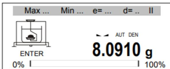
Coloque el material en la bandeja superior (medición en aire) y pulse ENTER.
