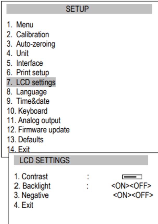
Los ajustes de la pantalla LCD permiten ajustar el contraste y la luz de fondo.
