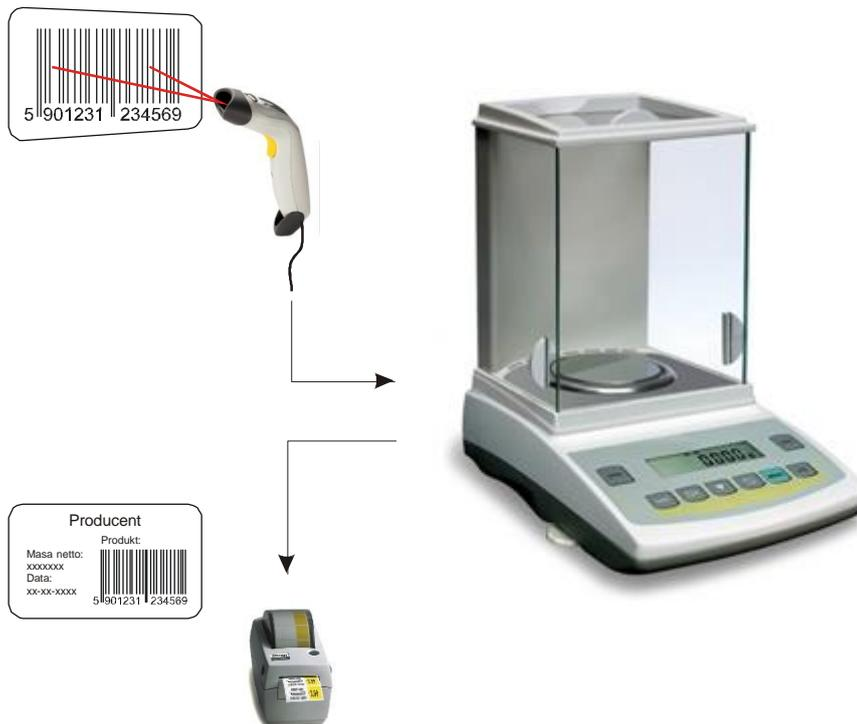
Después de seleccionar el producto y el usuario es posible enviar (al ordenador o a la impresora) la indicación de la escala real con datos adicionales, seleccionados mediante la opción PrInt (SetuP) (Configuración de impresión):
