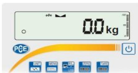
Espera hasta que el resultado de pesaje se promedie – la pantalla de la balanza parpa de a. Después la balanza mostrará un resultado estable (promedio) y lo enviará a través del puerto de serie.
