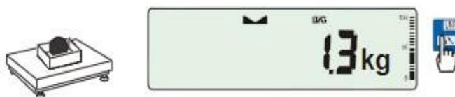
Para leer el peso bruto, pulse la tecla
