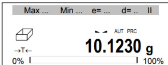
La balanza está lista para pesar los ingredientes de forma sucesiva, y después de cada ingrediente es necesario pulsar la tecla →T←. A balanza se pondrá a cero y a la izquierda aparecerá la suma de los ingredientes pesados previamente ( $\Sigma$ ) y su número (n)
